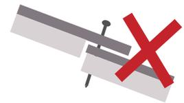
Causan percolación de agua de condensación
